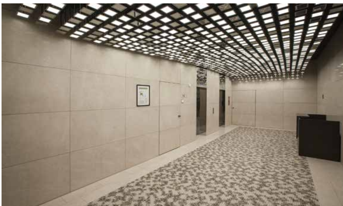
Abb.: Bei der OLED Lichtdecke bestand eine große Herausforderung darin, das Kostenbudget mit einer optisch möglichst attraktiven Lösung zu erreichen. Deshalb wurde auch mit Spiegeln gearbeitet, deren Oberflächen und Rahmen an die OLED-Leuchten angepasst sind.
